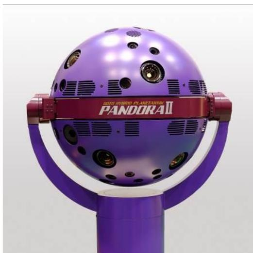
パンドラⅡは約4,000万個（主恒星約9,500個を含む）もの微小な恒星を再現し、美しい星空を提供することが出来るハイブリッド対応の光学式プラネタリウムです。恒星球の直径は約48cmで、新しいLED光源と高効率な冷却構造の開発によって光源の高輝度化、低消費電力化に成功し、新設計の投映光学系と組み合わせることで従来機（パンドラ）よりも明るく、かつ小さな恒星像を実現することを可能としました。また、パンドラでは搭載されていなかったデジタルシャッター※を搭載したことで、傾斜型プラネタリウムへの導入も可能になりました。水平モードや傾斜モードはもちろん、全開モードで客席まで恒星の光をこぼすなどの多彩な演出も出来ます。
